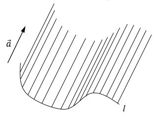
Линия l называется *направляющей* цилиндрической поверхности, а прямые – *образующими* цилиндрической поверхности.
