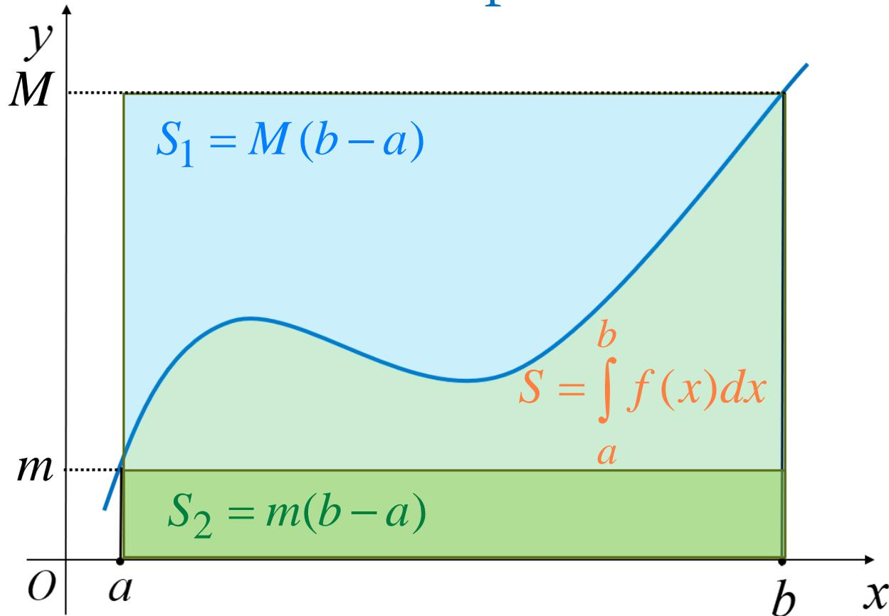
Площадь  $S$  под графиком функции  $y = f(x)$  меньше или равна площади  $S_1$  прямоугольника с основанием  $b - a$  и высотой  $M$ , но больше или равна площади прямоугольника  $S_2$  с основанием  $b - a$  и высотой  $m$ .
