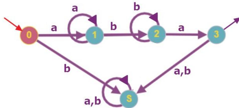
2) Из вершины 1 идет дуга до вершины 2 по букве  $b$  и дуга (петля) из вершины 1 по букве  $a$ :  $S_1 = bS_2 + aS_1$
