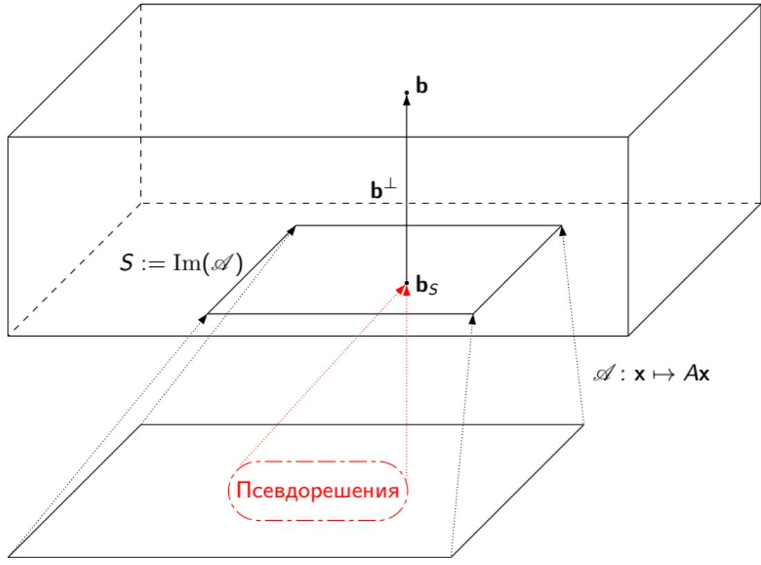
Концептуально подход, описанный и проиллюстрированный выше, прост. Однако вычисление ортогональной проекции с помощью процесса Грама–Шмидта приводит к громоздким и *неустойчивым* вычислениям.
