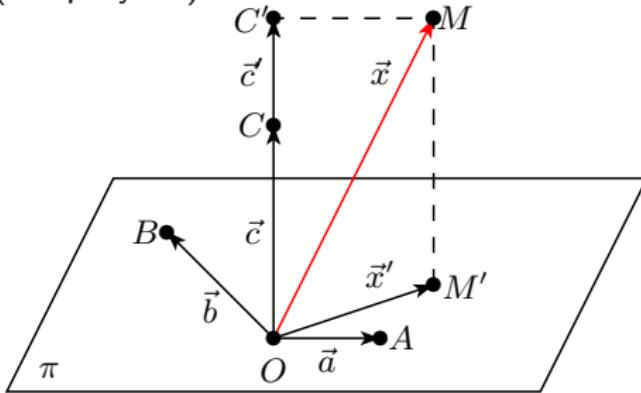
Поскольку  $\vec{a}$  и  $\vec{b}$  неколлинеарны, существует единственная плоскость  $\pi$ , проходящая через точки  $O$ ,  $A$  и  $B$ . Спроектируем точку  $M$  на плоскость  $\pi$  параллельно прямой  $OC$  и на прямую  $OC$  параллельно плоскости  $\pi$ .
